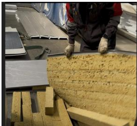
Рисунок 2. Осмотр минераловатных ламелей на линии
