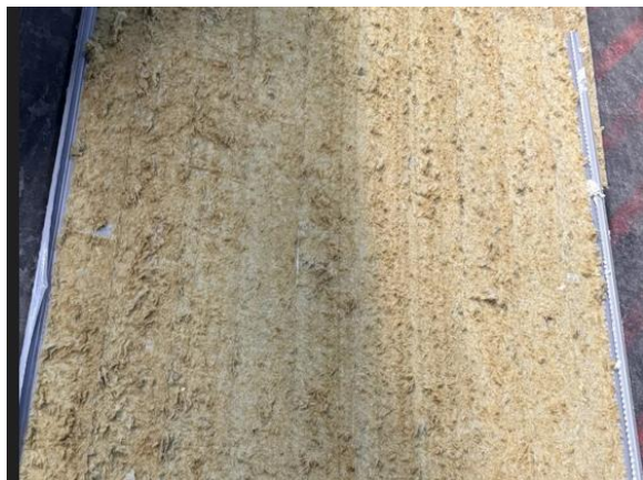
Рисунок 1. Состояние минераловатного сердечника в ходе испытаний
