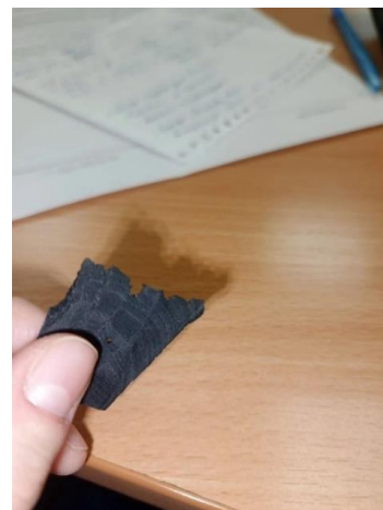
Фото 6–8 — Контрольное напыление и образцы, полученные при рабочем давлении 145 и 170 бар
