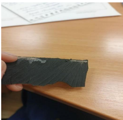
Фото 6–8 — Контрольное напыление и образцы, полученные при рабочем давлении 145 и 170 бар
